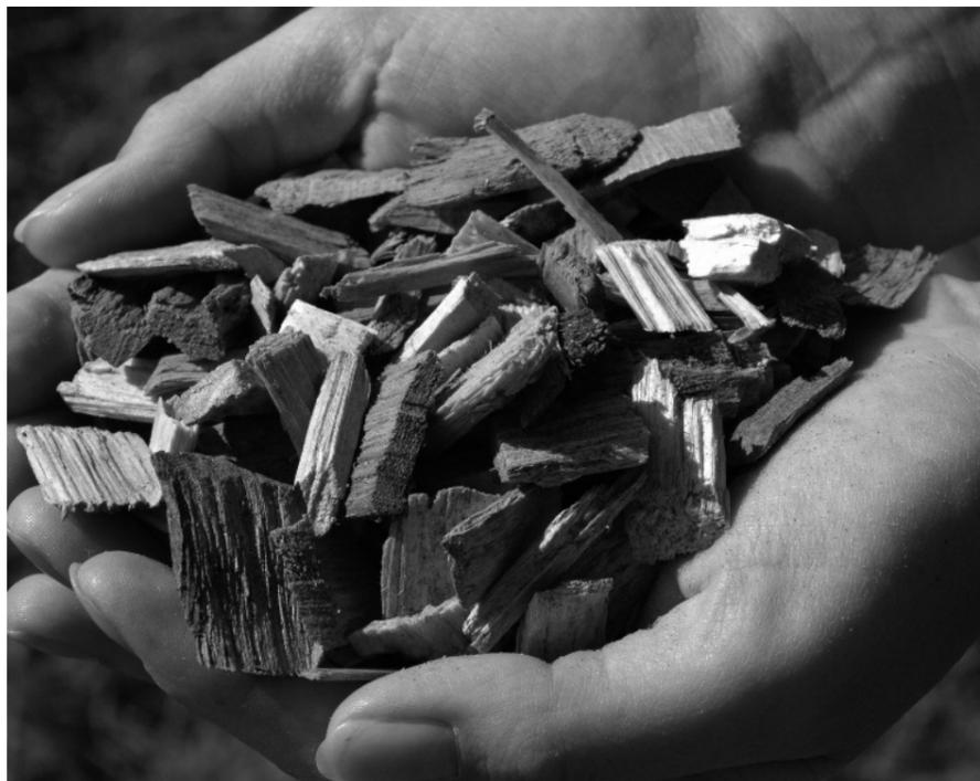
Kleinfeuerungen im Ganzjahresbetrieb zu feucht und zu grob sortiert. Bei kleineren Heizungen sind Störungen die Folge. Der normale Schnitzel sei eigentlich nur für den Winterbetrieb in grösseren Anlagen geeignet, die auf Volllast laufen, so Kym. Andererseits eigne sich nicht jede Pelletheizung für den Betrieb mit Qualischnitzeln.
